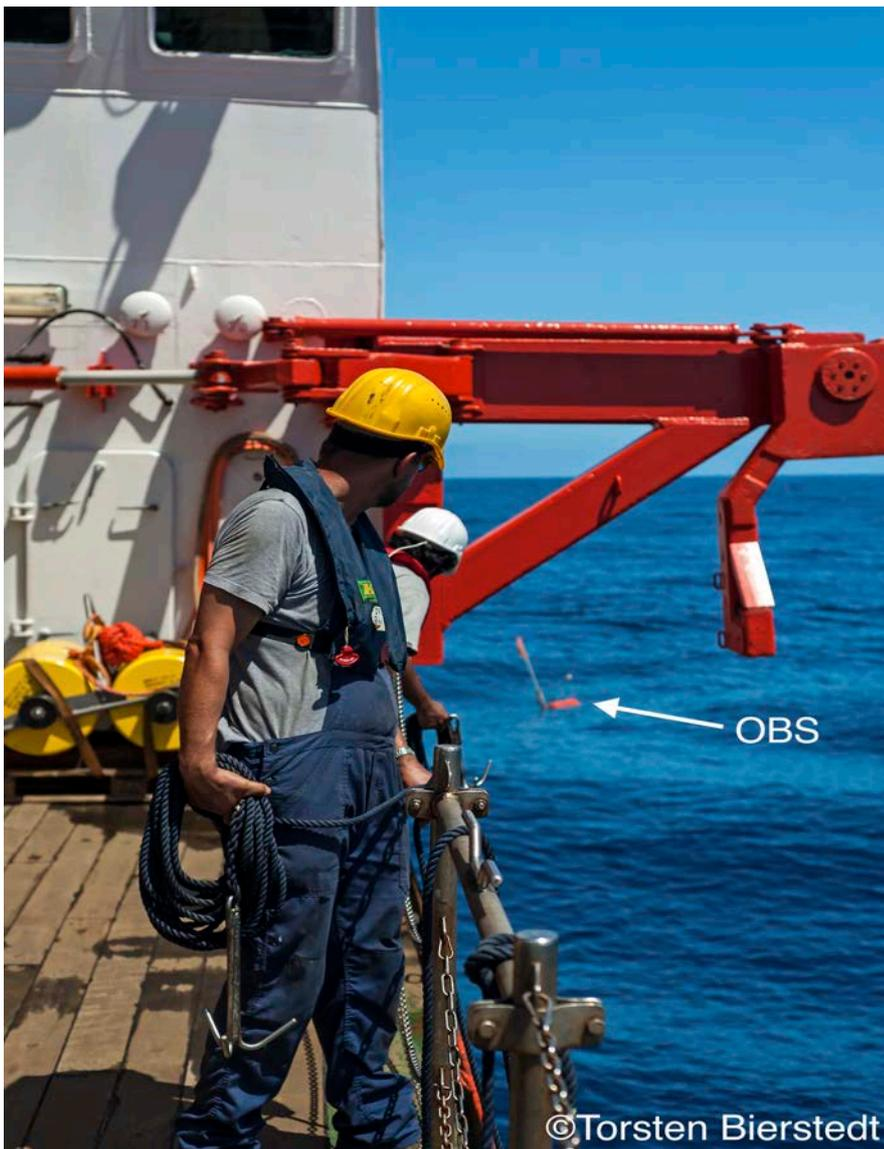
Bild 4: Nach Beendigung der seismischen Messungen schwimmen die Geräte nach einem akustischen Auftauchbefehl auf. Nun müssen die Geräte mit einem Enterhaken „eingefangen“ und an Bord gehievt werden.
