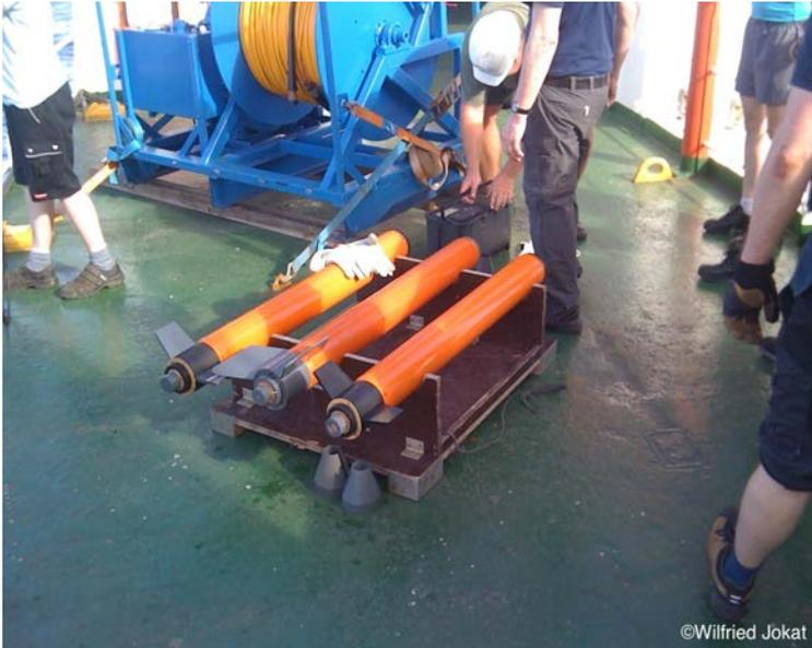
Bild 1: Die Magnetiksensoren werden an Deck für den Einsatz vorbereitet. Das dünne Zugkabel ist auf der Winde im Hintergrund aufgespult.
