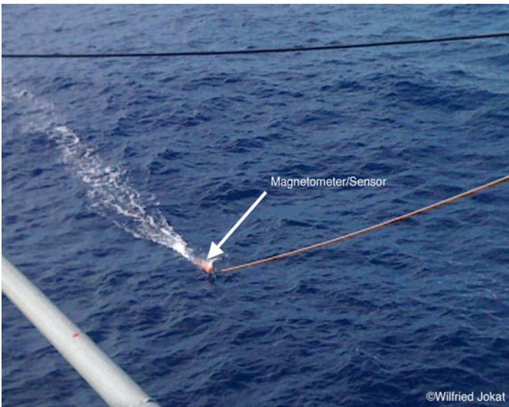
Bild 2: Ein Magnetiksensoren geht zu Wasser. Über das gelbe Zugseil werden die Daten auf das Schiff übertragen. Die Sensoren werden 900 – 1000 m hinter dem Schiff geschleppt.
