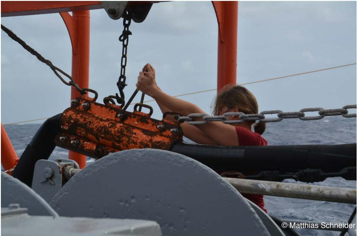
Bild 2: Das Luftpulsler Cluster wird wieder zusammen gesetzt.
