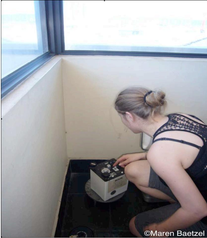
Bild 2: Einmessung des Referenzschwerewertes mit einem Landgravimeter im Gebäude der Hafenverwaltung (Durban).
