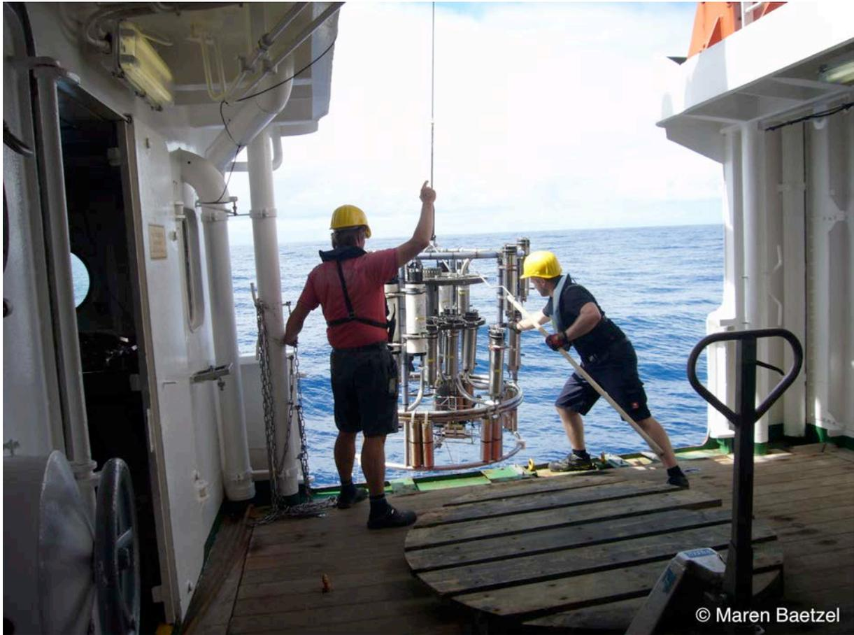
Bild 3: Einholen der CTD Sonde mit den OBS Releasern nach erfolgreichem Einsatz.
