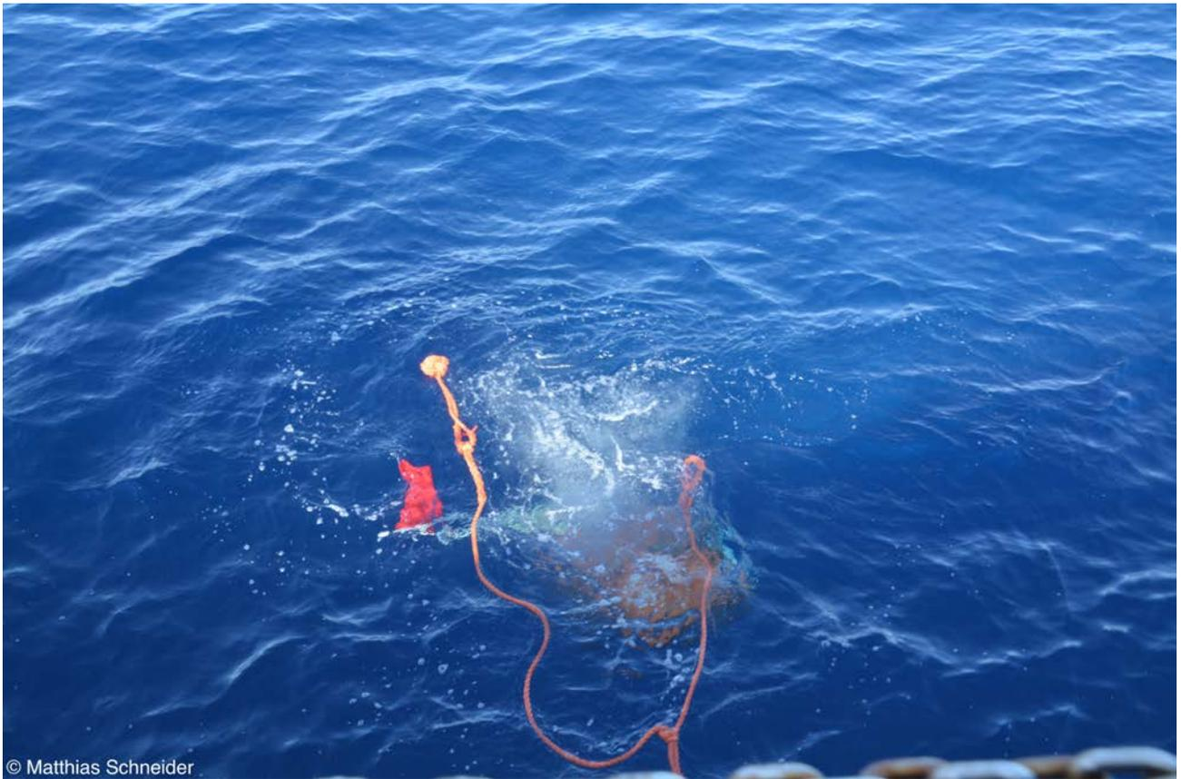
Bild 5: Das OBS taucht im freien Fall mit einer Geschwindigkeit von ca. 1 m/s ab. In etwa 30 Minuten wird es am Meeresboden ankommen.
