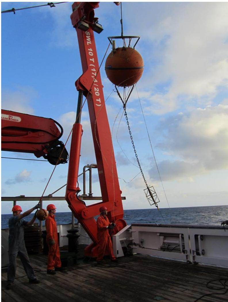
**Abb. 1:** Aufnahme der Kopfboje der Verankerung bei 8°N, 23°W. Direkt unter dem Auftriebselement befinden sich Sensoren zur Vermessung von Temperatur, Salzgehalt und Sauerstoff. Die Geräte befinden sich in einem Käfig und sind so gegen Beschädigung geschützt (Photo: Johannes Hahn).
