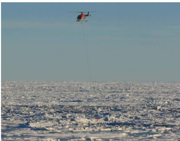
Bild des EM-Birds im Flug. Das Messinstrument wird vom Helikopter an einem 20 m langen Kabel in einer Höhe von etwa 10-15 Meter über die Meereisoberfläche geschleppt. (Foto: S. Hendricks)
