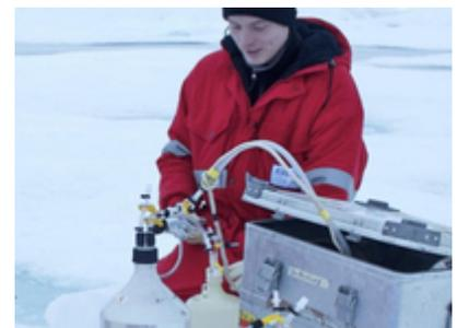
Wasserproben für die Thoriumanalyse werden unter dem Eis hervorgepumpt. (Foto: G. Dieckmann)
