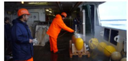
Ein profilierendes Messgerät wird nach der Aufnahme mit Süßwasser abgespült. Es hat vier Jahre lang Temperatur-, Salzgehalts- und Geschwindigkeitsprofile aufgezeichnet. (Foto: I. Waddington)
