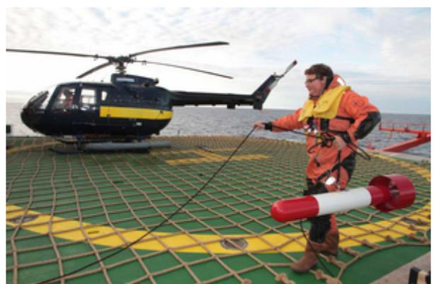
Vorbereitung auf einen aeromagnetischen Messflug; im Vordergrund die Flugsonde des Magnetometers. (Foto: U. Stüwe)
