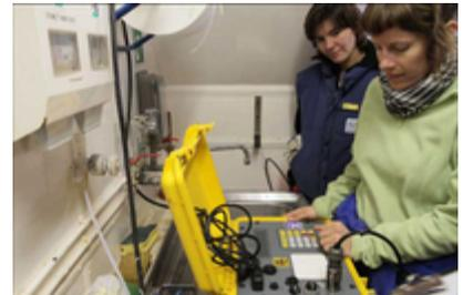
Der Releaser zum Auftauchen eines Ozeanbodenseismometers (OBS) wird ausgelöst. (Foto: M. Koch)
