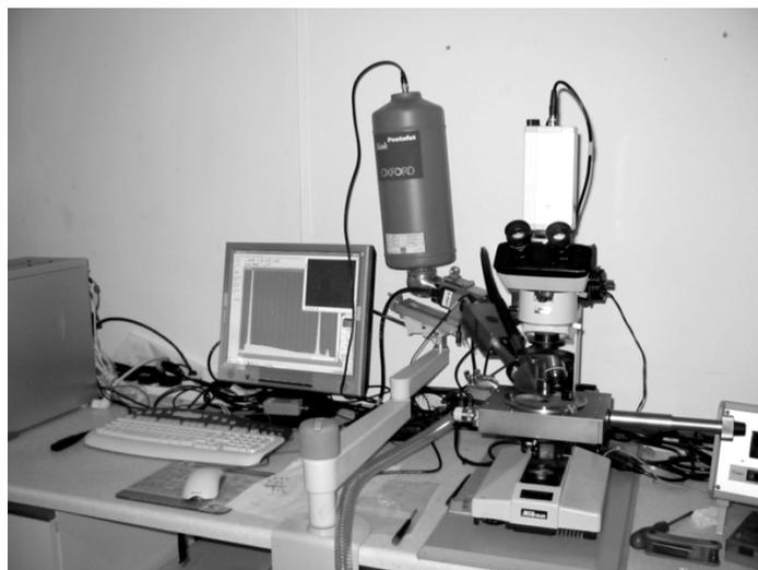
Fig. 7.11: CITL MK5 Electron Mini-Probe
