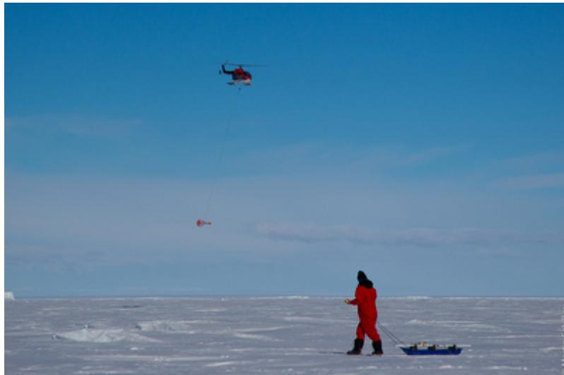
Abb. 3: Der vom Helikopter geschleppte EM Bird passiert das GEM. © Martin Schiller, AWI
