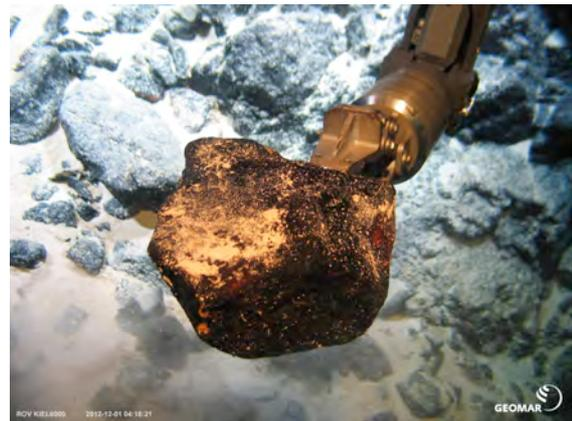
*Der Manipulator des ROV birgt eine Gesteinsprobe aus der Ostflanke der Danger Island Troughs.*
