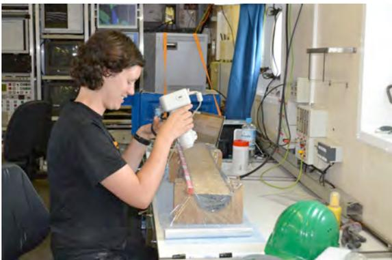
*Erste Untersuchungen an Sedimentkernen mit einem Farbscanner (Foto GEOMAR).*
