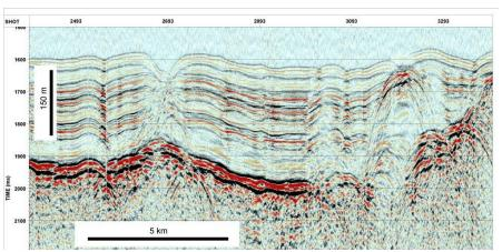
meistens um ca. 20% reduziert, allerdings erschweren Diffraktionen die genaue Abbildung der internen sedimentären Strukturen. Ein Post-Prozessing der seismischen Daten und die Einbeziehung von Daten
