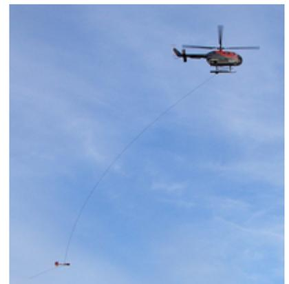
Abb. 3: Magnetiksensord wird 30 m unterhalb des Helikopters geschleppt
