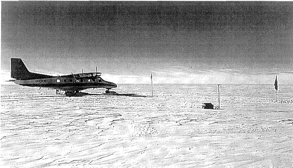
Abb. 65: Das Flugzeug *POLAR4* auf dem Amundsenisen an der Position DML10. Von den drei Stangen markiert die linke das Bohrloch und die verbliebene Temperaturmeßkette, die rechte den Platz wo der Schneeschacht gegraben worden war und die mittlere Alu-Stange ist der GPS-Meßpunkt. Man beachte die relativ glatte Schneeoberfläche, die sich gut für Landung und Start eignete. (Foto: H. Oerter, 30.01.97)
