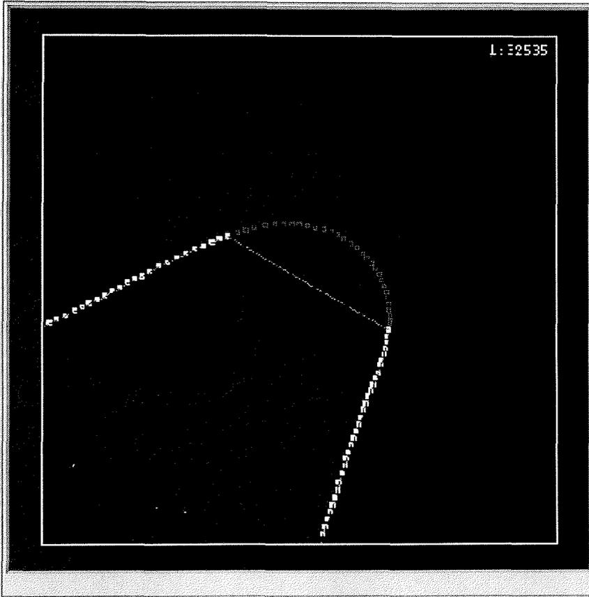
Abb. 17: Probleme beim Editieren von Navigationsdaten in einer Kurve. Für Navigationswerte, die von der HDCS Software nicht akzeptiert werden, werden interpolierte Werte erzeugt. Dies kann dazu führen, daß der Schiffskurs vollkommen falsch dargestellt bzw. berechnet wird.
