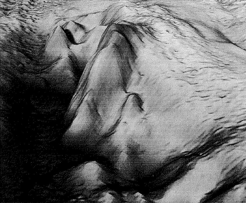
Abb. 20: Digitales Geländemodell (DGM) des Gingko Seamounts. Dieses Gebiet wurde in Zusammenarbeit mit der Arbeitsgruppe Geophysik kartiert. Der Seamount wurde auf einer Forschungsreise im Jahr 1996 mit Hilfe eines Echolots entdeckt. Er ist Teil einer südwestlich streichenden Fracture Zone. Die relative Höhe des Berges beträgt 400 m auf der Position 69.8°S 13.4°W. Aufgrund dieser Kartierung wurde eine Dredge Position an der steilsten Stelle ausgewählt.
